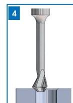
Schneidwinkel B Schneide 45°
